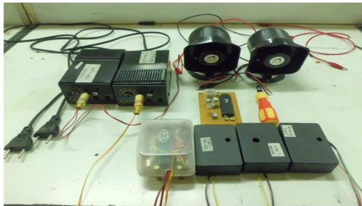
Gambar 6 Rangkaian pengontrol sistem pengusir burung pemakan padi
